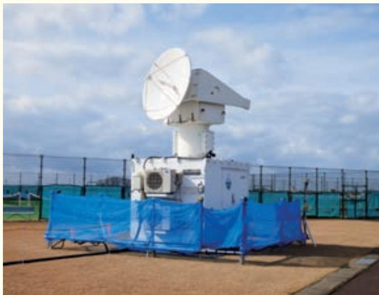
平成28年度と29年度の2年度にわたり冬季限定で、「Kaバンド雲レーダ」、「降水粒子撮像装置」を本学敷地内に設置しました。「Kaバンド雲レーダ」は同じ固形の降水粒子であっても氷なのか雪なのかを判別することが可能な、世界にも10台程度しかない最新の装置です。「降水粒子撮像装置」はその結果を地上に落下してきた降水粒子の形状と突き合わせることで検証するものです。研究は名古屋大学や山口大学などと共同で行われ、実験は来年度末まで冬季に行われます。
