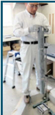
鋼球を使った落下衝撃試験
