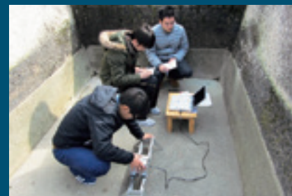
現地実証試験箇所での摩耗計測
