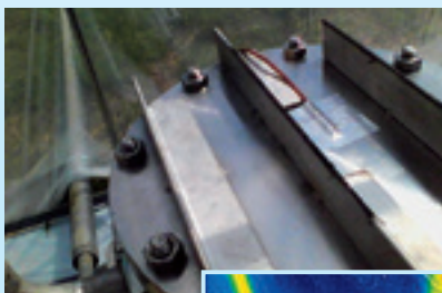
図1 夏のビニルハウス内におけるヒートパイプの上面温度（上：写真、下：熱画像）
